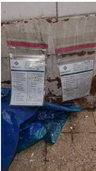
Plonge : PA17 Non Amiante
